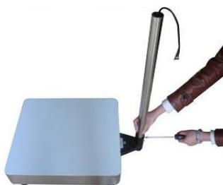
步骤二：将支架(3)装在在显示器(4)上面，将显示器(4)上的传感器接口穿过支架后锁紧螺丝(6)
